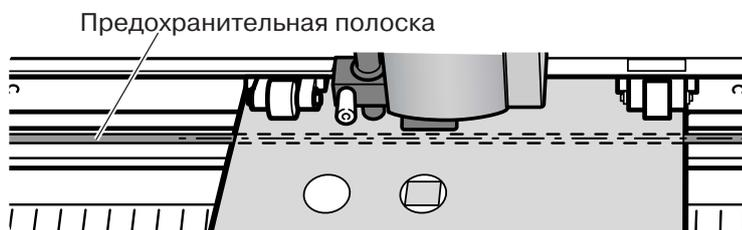
Нож двигается вдоль этой траектории. После установки начальной точки, областью резки будет служить область материала, находящаяся за пределами этой линии.
