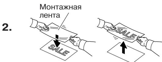
Отрежьте монтажную ленту до необходимого размера. Нанесите ленту на вырезанный материал. Не допускайте образования воздушных пузырей под лентой.
