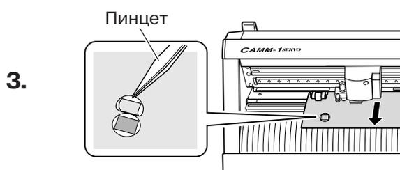
Нажмите **▼** для подачи материала вперед. С помощью комплектного пинцета отделите вырезанный участок и проверьте качество резки.
