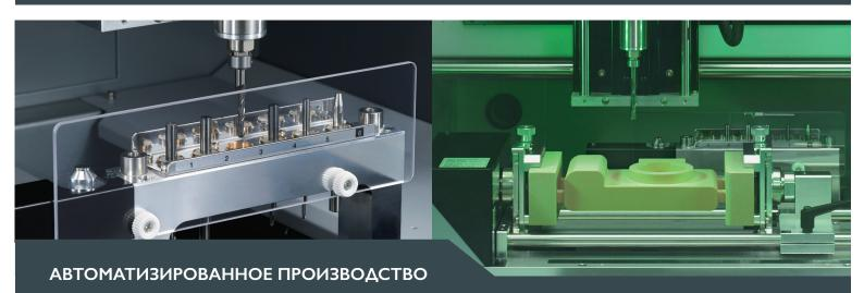
Автоматическое функционирование, не требующее участия оператора, обеспечивает высокую производительность В стандартной комплектации фрезерный станок MDX-50 оснащен устройством автоматической смены инструмента, поэтому может работать днем и ночью без участия оператора. Функция автозамера инструмента позволяет выставлять ноль по поверхности автоматически и абсолютно точно, обеспечивая прецизионность выполнения любой
