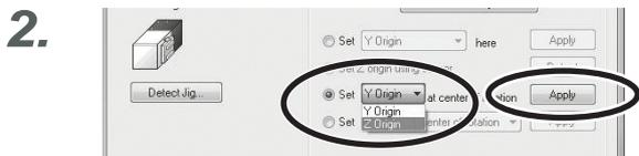
Выберите [Set the position of "Z origin" to the center of rotary axis] на Vpanel и нажмите [Apply].
