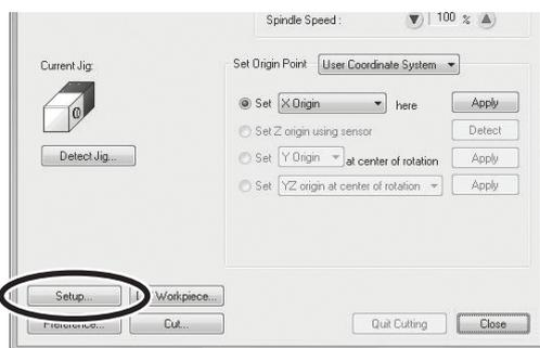
**Закройте переднюю крышку и на Vpanel нажмите [Setup].**
